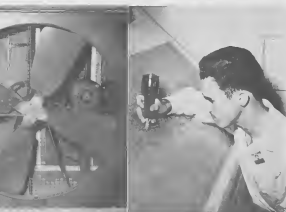
APLICACIONNAN DI motor electrico stranjy y no asma stranjy ta muestrá arriba. Motorman di forza di cabal fraccionario la move un cortador di azeta, arriba, y stof di un pintor di mapa, banda drechi. Un motor mas grandi ta necesario pa drasi e fan di cuatro pia den Paint Shop.
